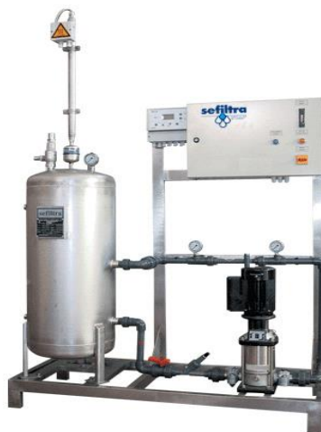
Figura 1. Equipo Generador de Ozono de la empresa dedicada a la purificación de fluidos SEFILTRA.
